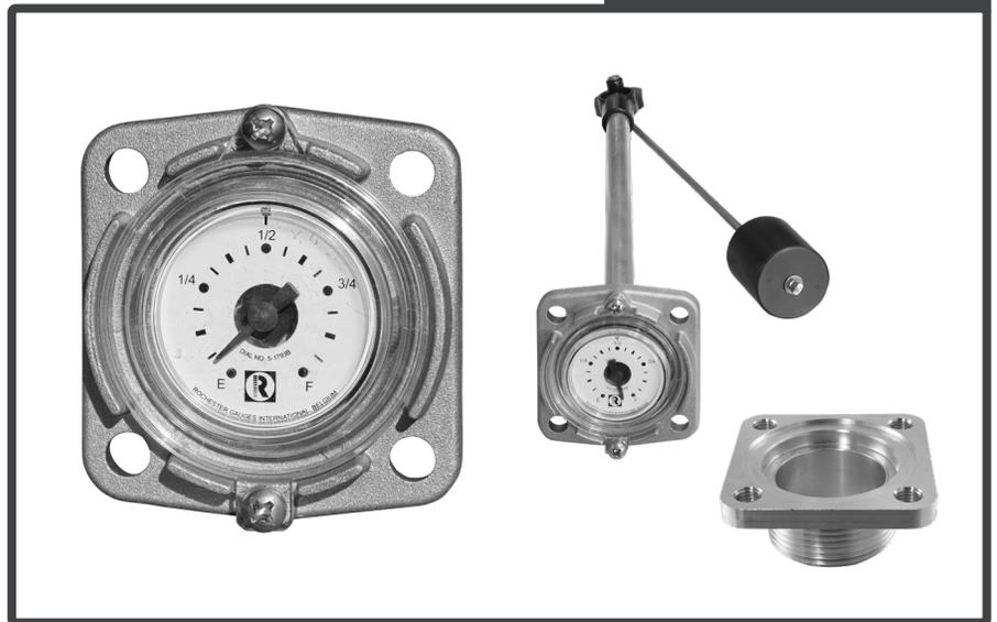
El indicador de nivel está diseñado para usarse en tanques que contienen diésel y aceites lubricantes. Es adecuado para aplicaciones como equipos de construcción, generadores estacionarios, embarcaciones, equipos agrícolas y sistemas de calefacción doméstica. Se monta en la parte superior del tanque y su mecanismo de engranaje central, junto con una palanca y un flotador de caucho nitrilo, proporciona la medición precisa del nivel del líquido.
