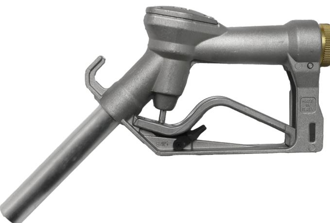
Las pistolas manuales destacan por su rendimiento confiable, resistencia en flujos bajos y manejo sencillo, además de su excelente relación costo-beneficio. Gracias a su diseño versátil, pueden instalarse fácilmente en diversos sistemas de traspase, incluso en aquellos que operan por gravedad. Se entregan equipadas con protector de palanca desmontable, múltiples opciones de roscas para distintas conexiones y un tubo de sección reducida, ideal para el uso con gasolina.
