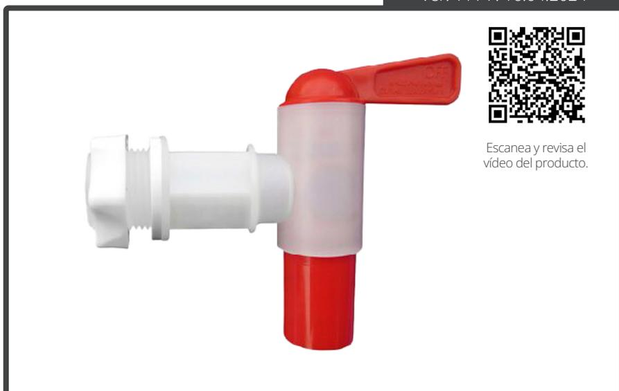
Esta llave de alto flujo jumbo con contra tuerca de  $\frac{3}{4}$  y espiga de vaciado de 18 mm permite un caudal de salida de hasta 296 ml/s que es significativamente mayor a las llaves convencionales. Es de sube apertura y cierre medite palanca permitiendo un preciso control del flujo.
