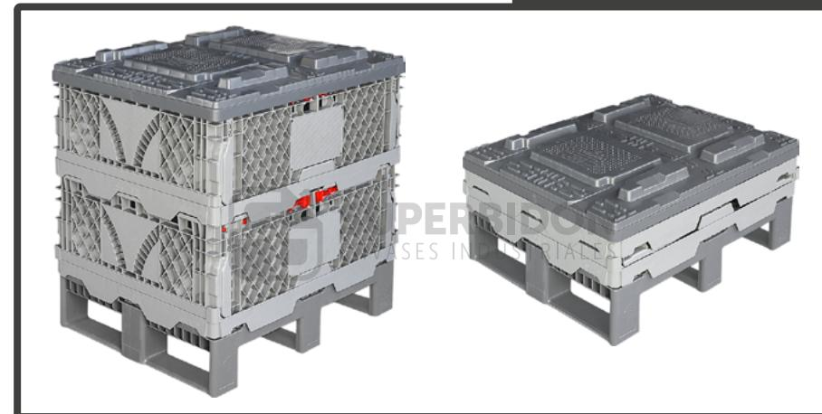
El mini bins plegable de 244 litros integra un mini palet CR2, dos collares CC2 y una tapa de PE, conformando un contenedor reutilizable que, al plegarse, reduce su volumen hasta en un 75 %. Cada collar aporta 122 L de capacidad, mientras que el palet base soporta 2 000 kg en carga estática y 500 kg dinámica. Este sistema proporciona protección, trazabilidad y gran ahorro de espacio en transporte de retorno.
