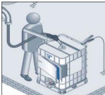
Figura N°4 conexión puesta a tierra
