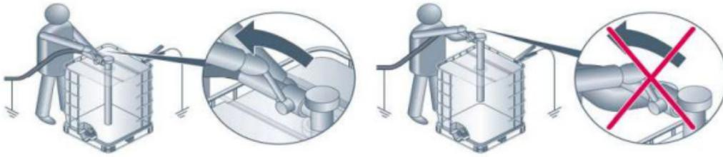
Figura N°6 Carga por tubo de inmersión
