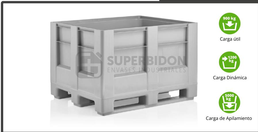
El Bins Cerrado Reforzado de 620 Litros está desarrollado para entornos donde la higiene, la seguridad estructural y la compatibilidad con sistemas automatizados son esenciales. Fabricado en dos elementos moldeados por inyección, el cuerpo superior y el pallet con tres patines soldados, su diseño sin cavidades visibles, con paredes interiores completamente lisas y bordes redondeados, facilita el vaciado, la limpieza y el secado eficiente.
