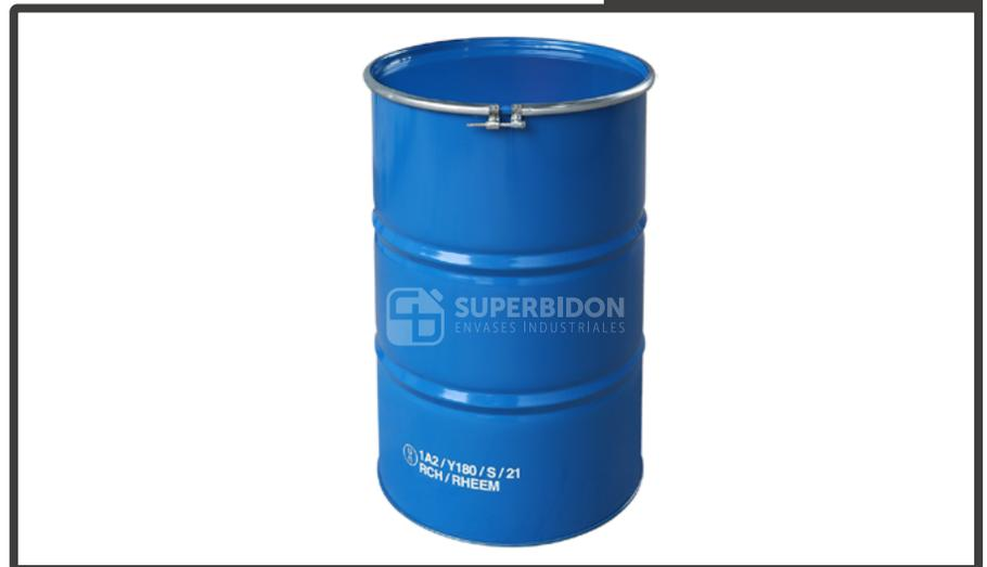
Envase metálico cilíndrico, equipado con dos rodones para facilitar su transporte. Con una capacidad nominal de 208 litros (55 Gl), este contenedor cuenta con una tapa removible que permite una fácil inspección del producto una vez envasado. La tapa, esencial para mantener la hermeticidad del tambor, está sellada mediante una empaquetadura tubular de caucho acrílico-nitrilo y asegurada al cuerpo mediante un aro de sección circular con un pestillo y perno.
